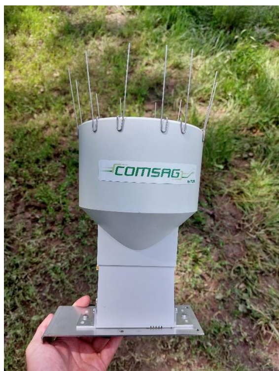
Annexe 4 : Pluviomètre Comsag
