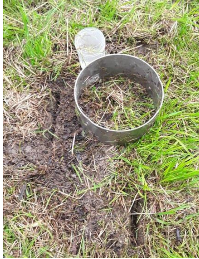
Figure 10 : Mise en pratique du test de vitesse d'infiltration d'eau dans la zone piétinée scarifiée du verger P24
