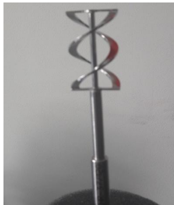
Figure 6. Le mobile de mesure en hélice hélicoïdale
