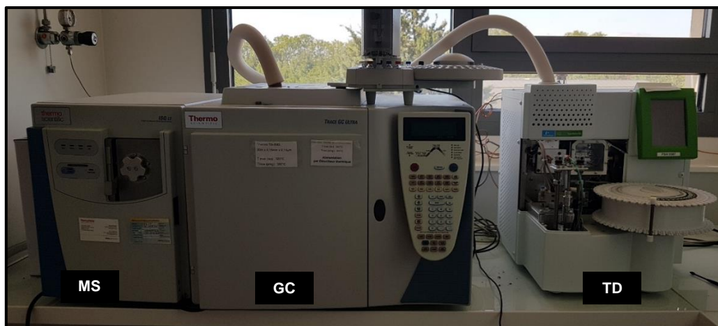
Figure n° 13 : Photographie du thermodésorbeur (TD), de l'analyseur de gaz (GC) et du spectromètre de masse - ISQ (simple quadripôle) (MS).
