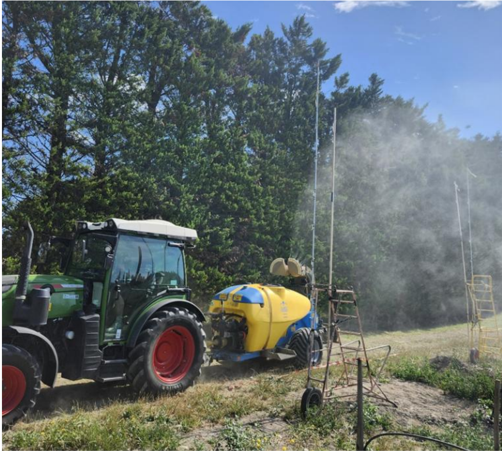
Figure 20 : Disposition des perches et passage du pulvérisateur pneumatique (C. Metayer)
