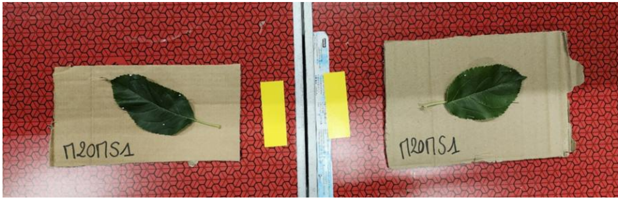
Figure 15 : Positionnement des feuilles et des papiers hydro sensibles lors de la pulvérisation (C. Metayer)
