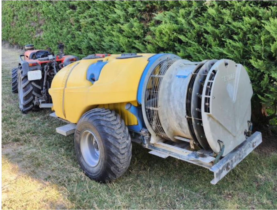
Figure 5 : Pulvérisateur arboricole, trainé, à jets portés (C. Metayer)
