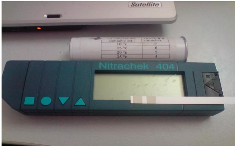
Nitracheck pour mesurer l'azote du sol en unités de NO<sub>3</sub> en ppm
