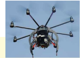
Drone MikroKopter Oktokopter, altitude 40-150m
